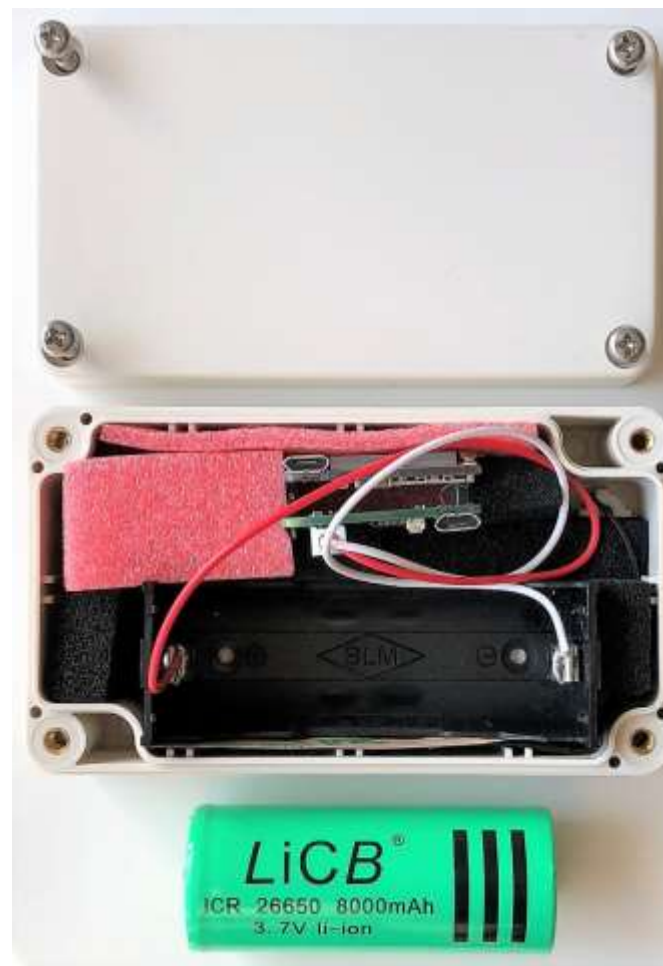
上記写真の8000mAhのリチウムイオン電池で約4ヶ月ほど稼働し続けます
